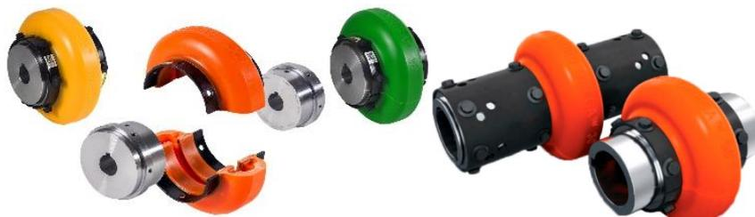
Los Acoplamientos Omega están diseñados para proporcionar una conexión mecánica entre los ejes rotativos del equipo mecánico, mediante un elemento torsionalmente flexible para aceptar desalineaciones y transmitir la potencia y el torque entre los ejes.
