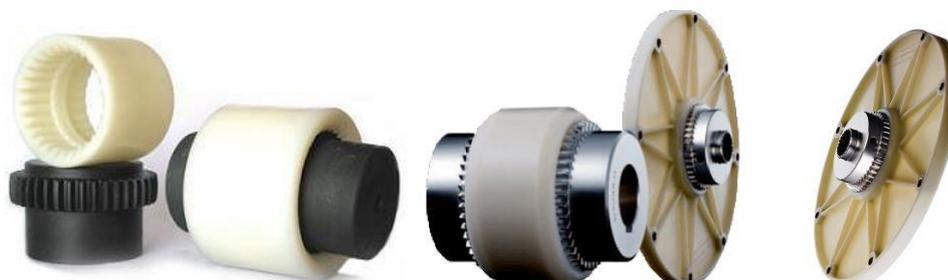
Los acoplamientos Bowex de engranajes de dientes abombados son conexiones flexibles. Es adecuada para compensar desalineaciones de ejes causadas por inexactitud de fabricación, dilatación por calor, etc.
