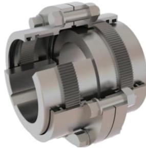
El acoplamiento de engranajes está compuesto por un manguito dentado interno y cubos dentados externos que tienen la misma cantidad de dientes y otros componentes. Cuando está en movimiento, se produce un desplazamiento relativo entre dos ejes, y las caras de los dientes internos y externos se mueven relativamente en dirección axial.
