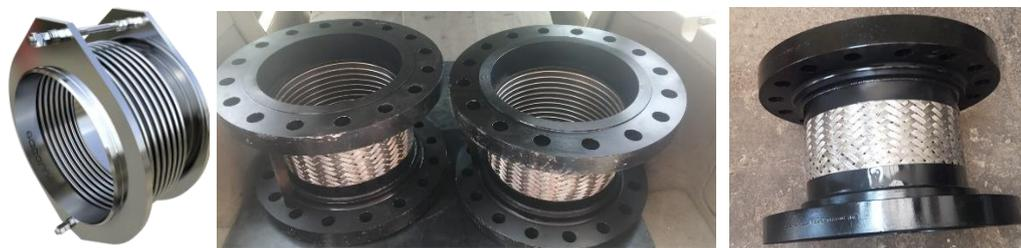
El elemento básico de una junta de expansión metálica (o compensador de dilatación metálico) lo constituye el fuelle de metal corrugado anularmente a partir de un tubo soldado longitudinalmente o tubo sin costuras, en construcciones de una o varias ondas de diferentes espesores. Diseñados y fabricados en conformidad a los datos de diseño y a las diferentes normativas.
